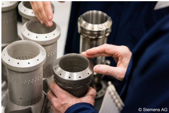
Gasbrenner im 3 D Verfahren der Firma Siemens
